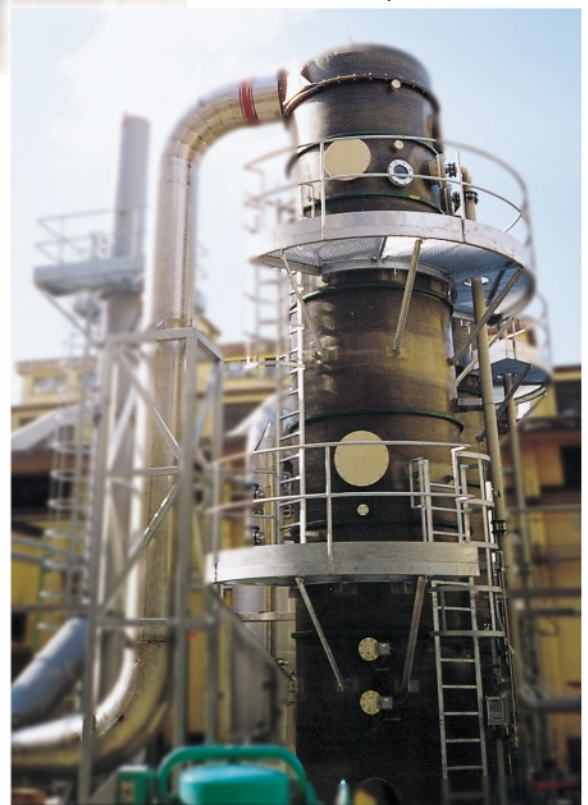
Torre di lavaggio a corpi di riempimento Scrubbing tower with filling bodies
